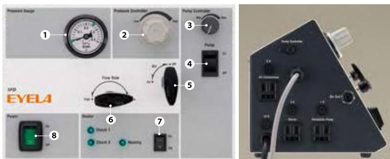
喷雾造粒操作可通过集成的操作板进行，通过调节送液量和喷雾压力来控制粒径。
