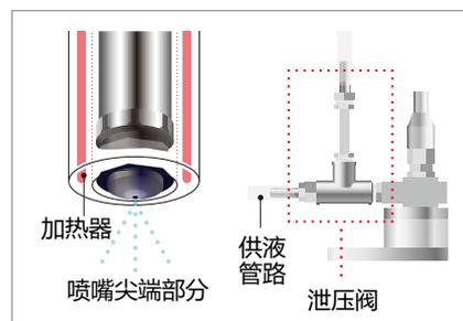
喷雾高度位置可通过旋钮螺栓 (PAT.P) 进行调节，从而对回收率和粒径进行调整。旋钮螺栓高度位置设有标尺，所以具有良好的实验再现性。盖部配有排气嘴，造粒容器内的氮气可以全部排出，所以通风橱外可进行操作。
