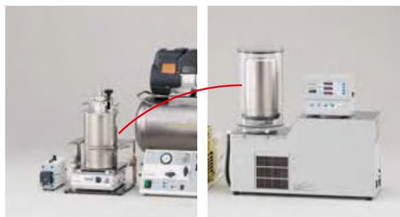
喷雾冷冻后，真空绝热容器可直接转移至冻干机的干燥仓内，无需更换容器即可轻松完成一系列干燥过程。
