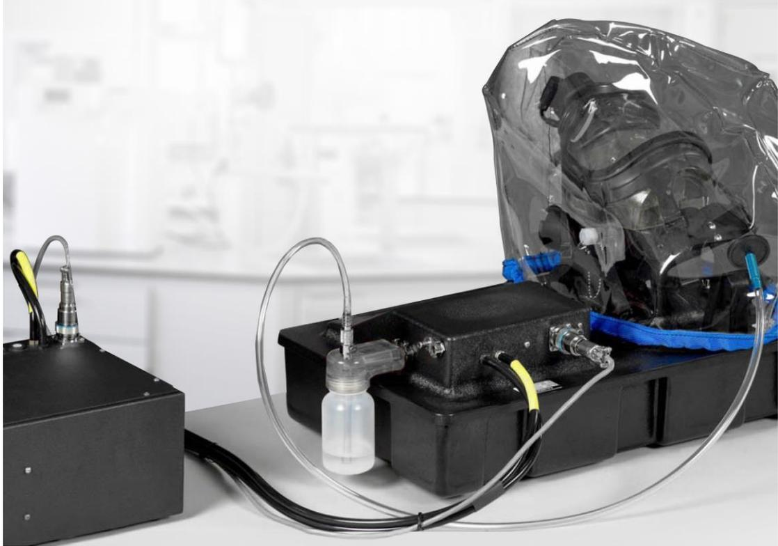
当你戴上防护面具时,你应该对你的装备充满信心。ATI 公司的防护面罩泄漏测试仪(PMLT)是一种基于气溶胶和光度测定的仪器,旨在确认面罩的密封性和完整性以及个人的适合性。PMLT 是便携式的,易于使用,设置在分钟内,并提供了各种面具测试选项。PMLT 是唯一一种能够在不影响面罩的情况下对整个面罩进行泄漏测试、对面罩组件进行完整性测试以及对个人进行配合测试的仪器。PMLT 使用了美国军方和 NIOSH 使用的相同技术来测试为满足严格的化学-生物-放射和核(CBRN)要求而设计的面罩。此外,PMLT 已经通过联合项目执行办公室(Joint Program Executive Office)作为联合军种防毒面具泄漏测试仪(JSMLT),接受了美国军方的积极测试和部署。
