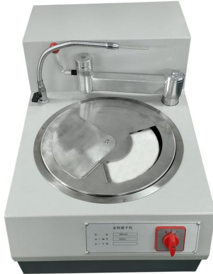
在金相试样制备过程中，经切割后的试样表面或未加工的试样表面均比较粗糙和不平。为了提高试样的后续的研磨质量和工效，可先将试样的粗糙面（切割面）在磨平机的砂轮上快速磨平，再进行预磨和抛光工作。该磨平机也可用于光谱样品的磨平。
