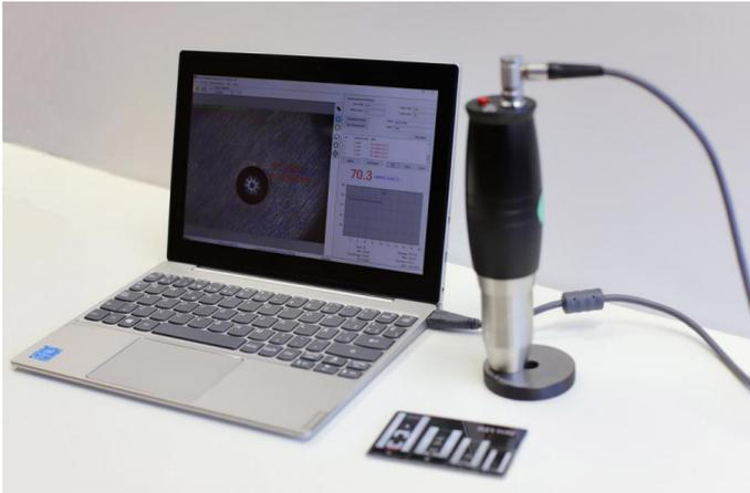
“HOYTOM – LHB”布氏压痕数字测量装置是一种便携式的测量系统，它可以快速、简单和精确的测量布氏压痕。此外，所有采集的图像、数据及测量结果均保存在内部的数据库中，方便随时调取。
