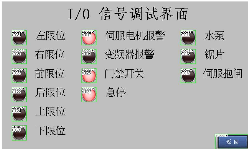
状态显示画面显示系统的状态，系统有故障时可进入这个画面检查系统的故障显示设备的功能及设备参数和注意事项。
