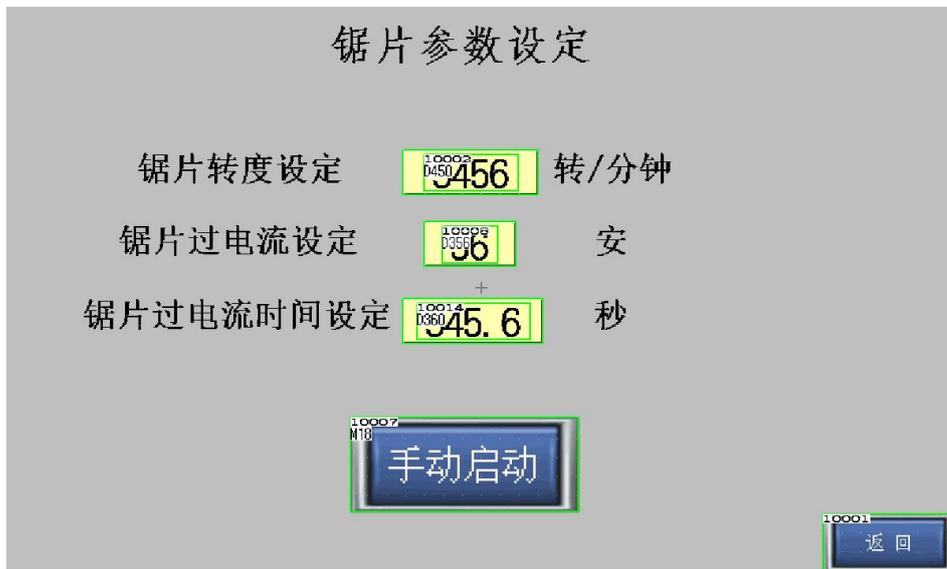
锯片参数设定根据不同切割工件的材质，硬度，砂轮片的直径来调节切割锯片转度设定，此款切割机最高转速 2600 转。在主画面主轴转速上下调节按键可随时调节主轴转速。锯片过电流设定：是为了更好的保护主电机的一个保护设定，当电机电流超过设定值后达到电流时间设定后电机将停止运行，设备停止工作。这样更好的保护了主轴电机。出厂时锯片过电流设定 20 安，锯片过电流时间设定 5 秒。
