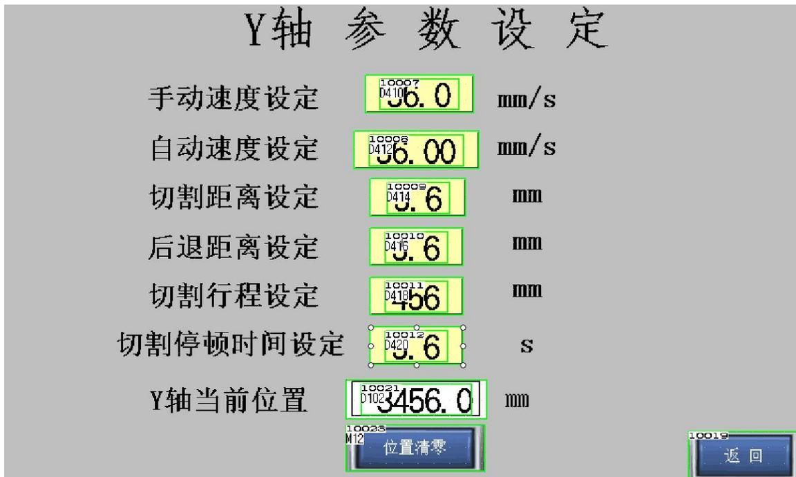
①手动速度设定：设定触摸屏上手动调节速度，可根据需要调节数值的大小来控制手动移动的速度，
