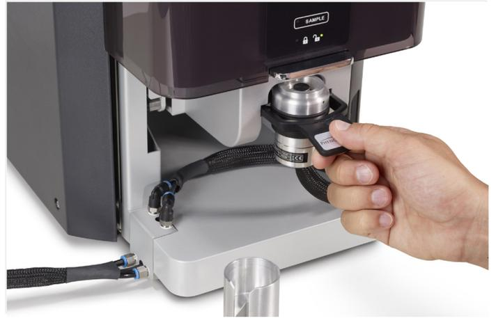
为了研究对真空度敏感的脆弱样品，飞纳和 Deben 合作研发了温控样品杯。这种样品杯可以控制样品温度，进而改变样品周围的湿度，最大限度地降低电子束和真空度对样品的损坏。
