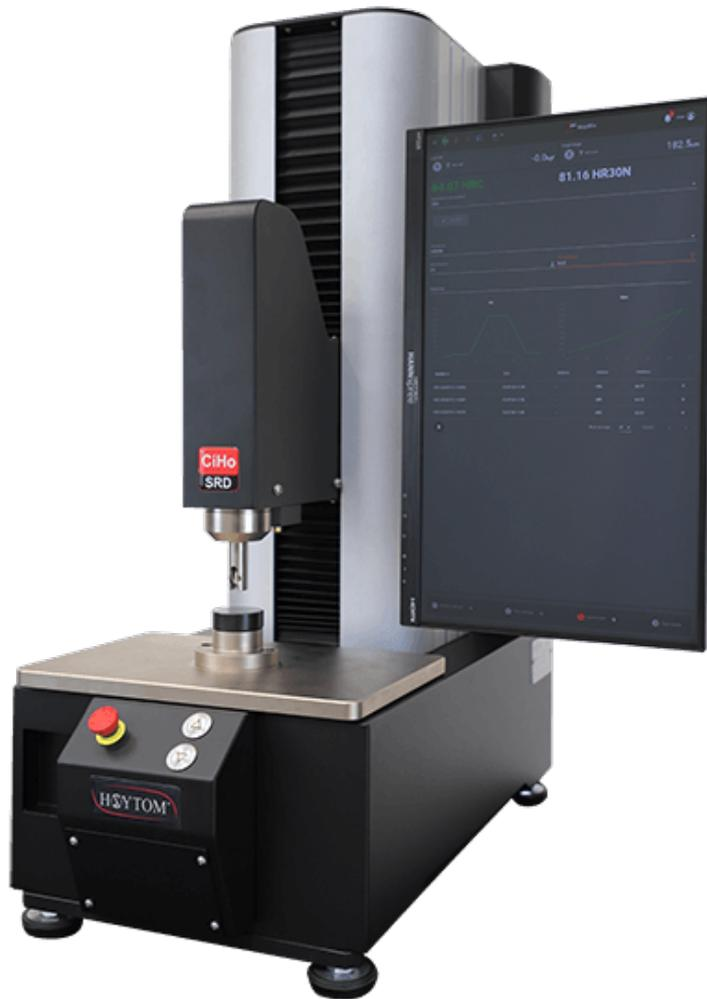
该机型开发是为了使用洛氏标尺(载荷分别为60、100和150kgf)和表面洛氏标尺(载荷分别为15、30和45kgf)进行测试,同时也可以为其它方面的测试提供额外载荷,如布氏或维氏硬度载荷。它是由一个电动的构架组成,其中包括载荷应用系统(由计算机控制的测力传感器系统)。
