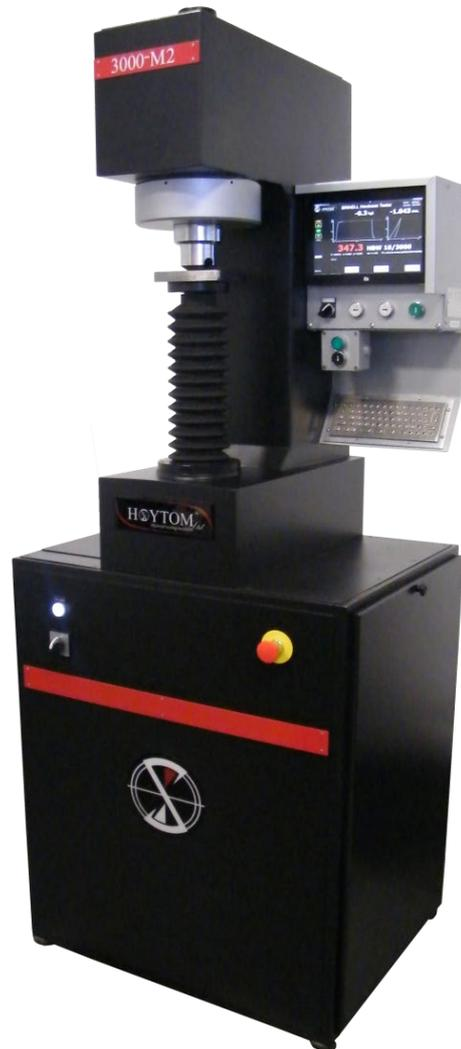
3000 M2硬度计可进行62.5至3000kgf范围内的布氏硬度试验，试验结束后根据布氏压痕深度测量法（HBWT法）自动显示布氏硬度值。这有助于快速、轻松的执行多次重复测试。
