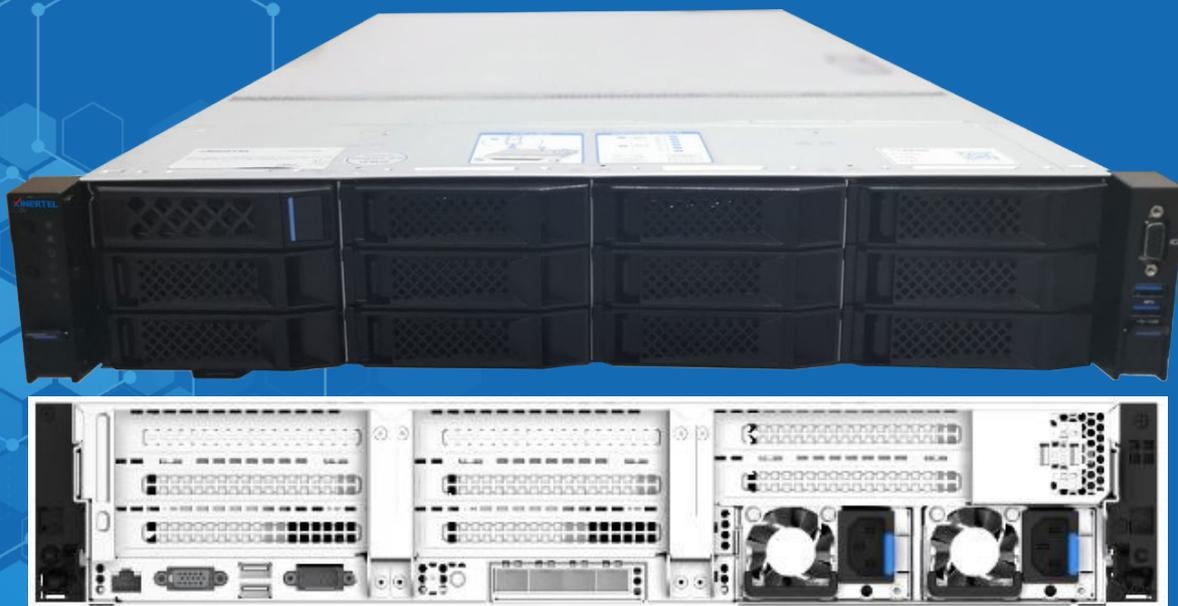
DarPeng 系列高性能网络应用安全测试仪是信而泰推出的面向三重播放语音、视频和数据应用及网络安全的高性能测试仪，通过精确仿真数百万的真实终端用户和网络行为，对单个应用层感知设备（如Firewall/IPS/IDS/WAF/DPI等）或整个系统进行压力和性能测试；通过仿真大量的真实攻击流量和恶意病毒流量，验证和测试网络安全设备和系统的检测和防御攻击和病毒的能力。
