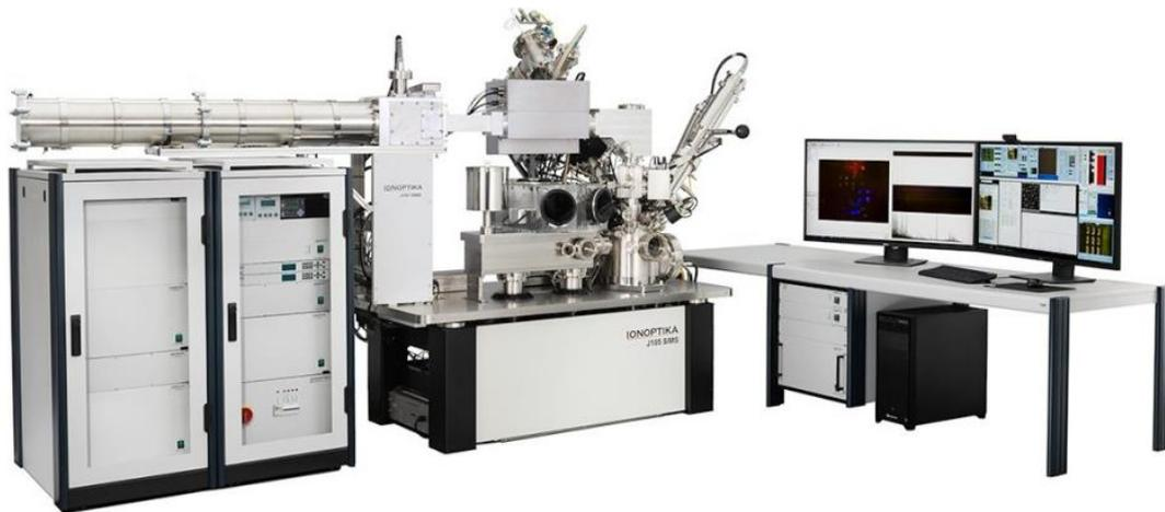
可以配备一系列用于分析的离子束，包括 40kV C60、40kV 或 70kV 气体团簇离子束和 25kV 金离子束，使其成为广泛材料分析的理想解决方案。团簇离子束使有机物的分析不需要碎裂，显示出高达 3000Da 的分子量，具有良好的灵敏度。
