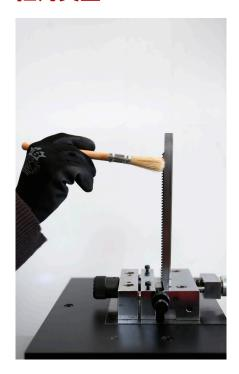
根据国际标准EN ISO148-1和ASTM E23在夏比和悬臂梁试样上开槽用的拉刀。
