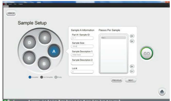
↑ ParticleX 软件设置助手引导用户完成自动化样品设置和分析工作流程。
