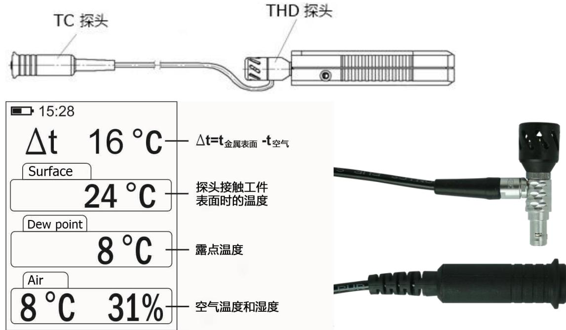
注：连接 THDC 探头时仪器显示屏上显示的数据。
