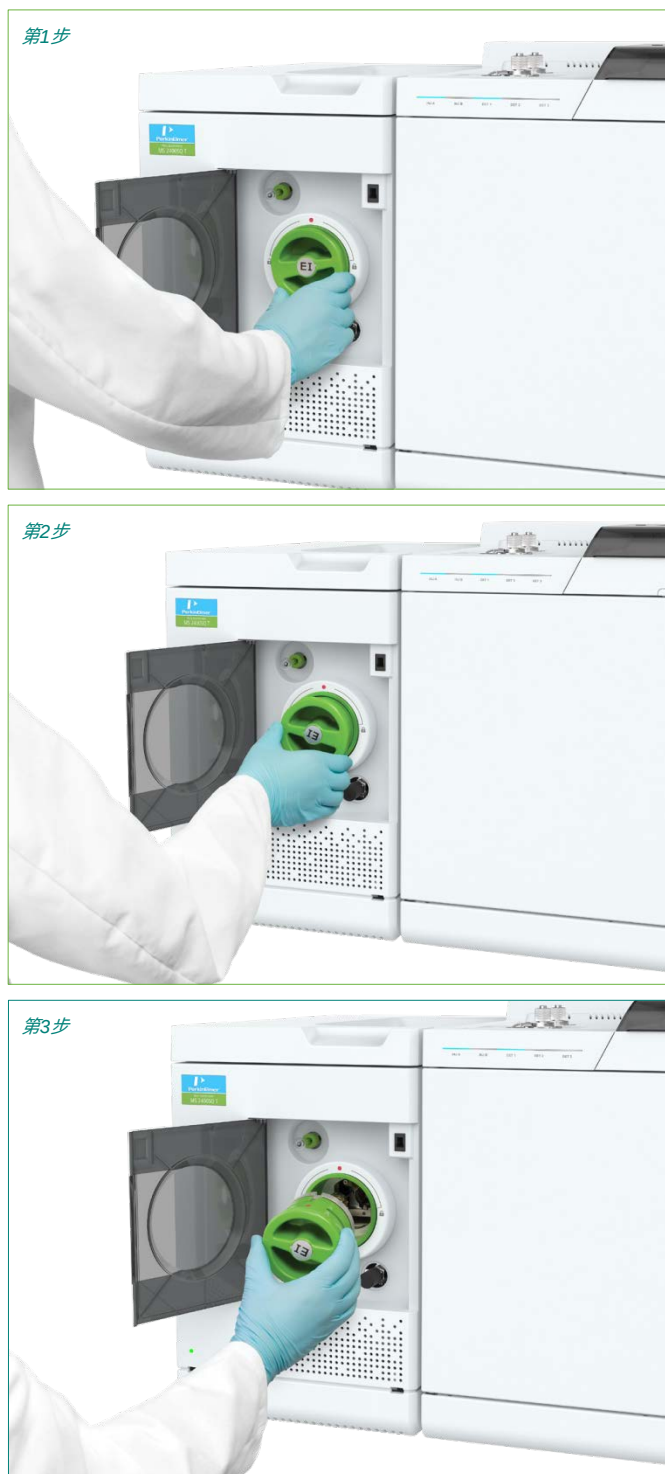
图 2：只需轻轻一拧并拉出，无需使用工具，即可取下MS 2400 SQ系统上的SMARTsource离子源。
