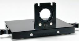
多用途透射夹可用于测量颜色及雾度，是按照ASTM D1003 B部的程序要求设计。将样品靠近积分球或光接收位置，可测量总透射和定向透射。此设计保证精确测量薄膜、塑料片及液体的颜色及雾度，并确保测试重复性。
