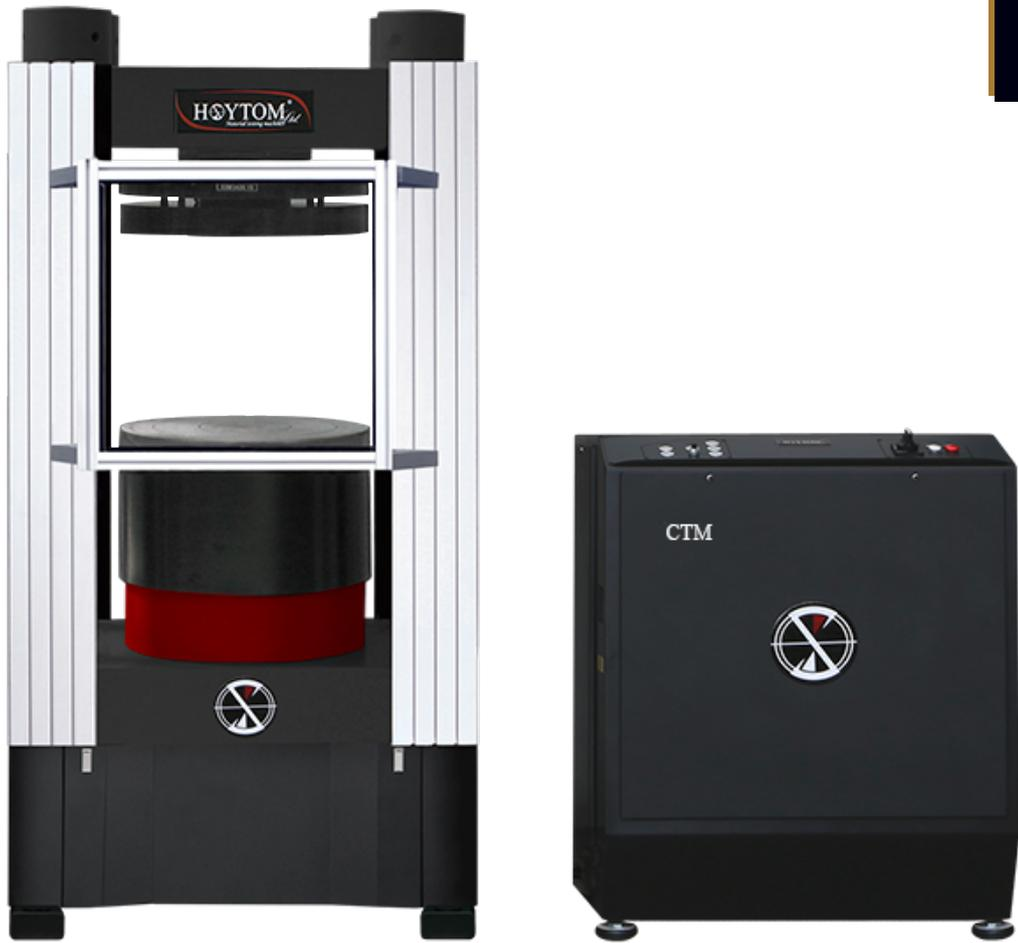
作为霍伊特PRO系列的一部分，CTM型液压试验机可实现最高达6000KN的试验力。该设备经过专门的设计，主要用于测试圆柱、立方体和棱柱形混凝土试样的抗压强度，并可根据相应的标准测试间接牵引力。
