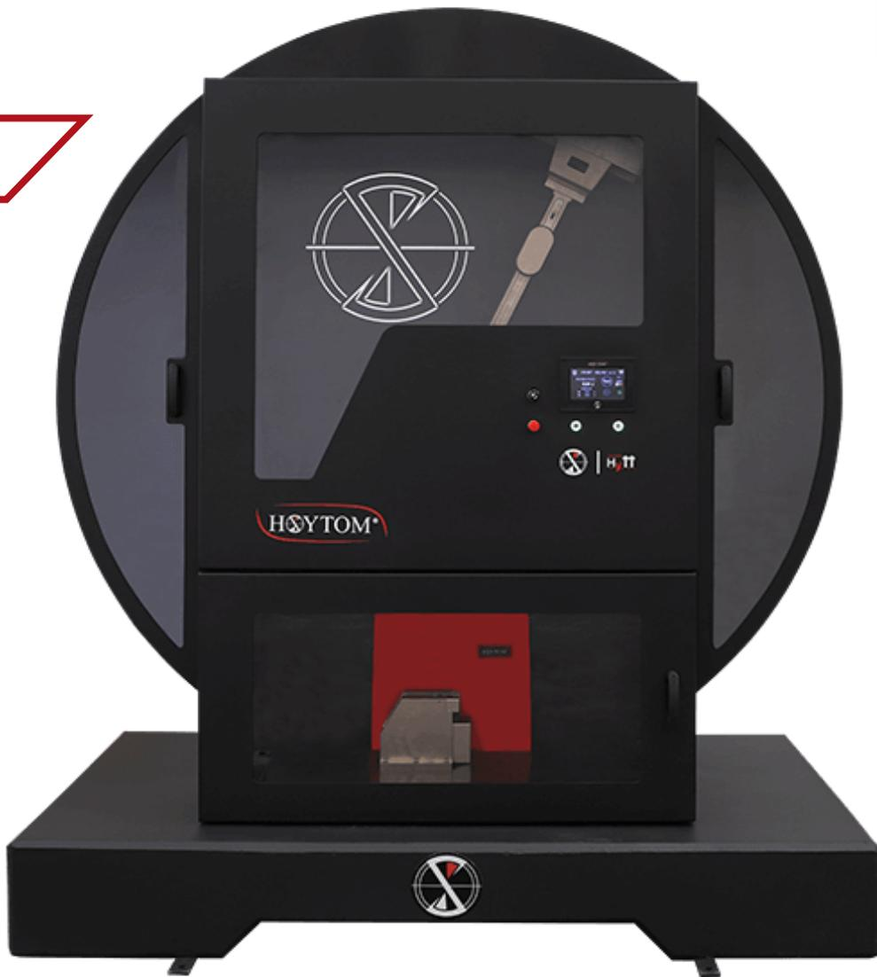
西班牙霍伊特HyTT摆锤式冲击试验机依据夏比或悬臂梁冲击试验标准，设计用于各类金属的冲击性能测试。其冲击能量范围在 300 至 750 焦耳之间。
