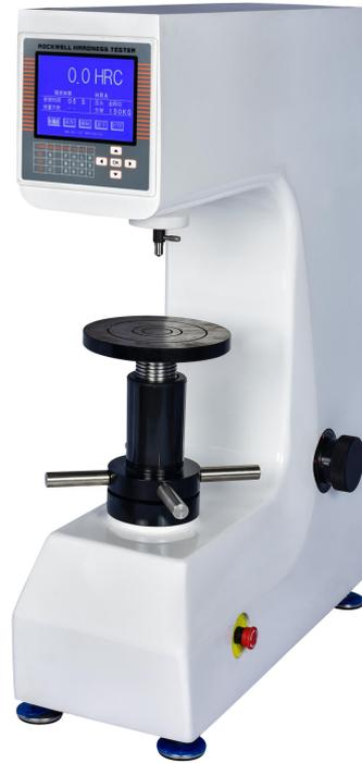
KHR-150D 数显洛氏硬度计外观新颖，界面菜单化，测量装置采用光栅传感器及计算机控制，硬度示值在液晶屏上直接显示是机电一体化的硬度测试仪器。
