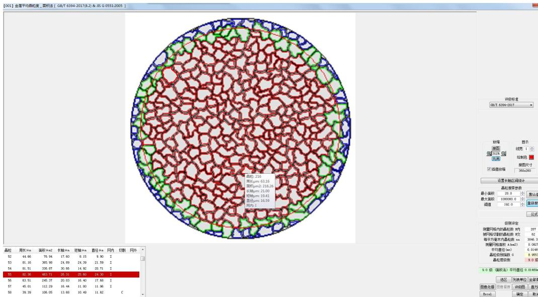
正确选择材料的执行标准，通过金相显微镜的摄像系统，把试样金相组织图片捕获拍照，进入评定级别界面：
