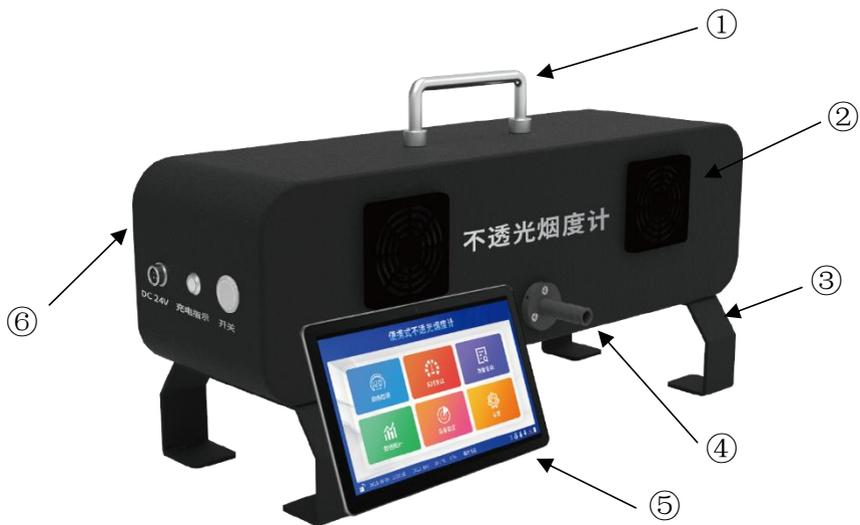
①把手 ②进气孔 ③支架 ④采样口 ⑤操作平板电脑 ⑥检测单元
