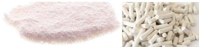
测试粉末 (>10  $\mu\text{m}$ ) 和成型吸附剂
