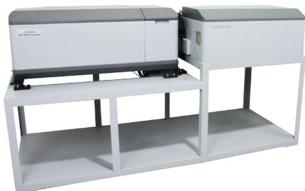
圆偏振发光光谱仪被设计为补充其他手性技术如圆二色性，提供激发态性质的手性信息。CPL-300使用Steinberg提出的原始180°荧光收集方法。标准无臭氧的150W Xe灯可以用Hg / Xe源替代。仪器的双棱镜激发和发射单色仪提供非常低的杂散光，并且没有由衍射光栅引起的寄生线偏振效应。
