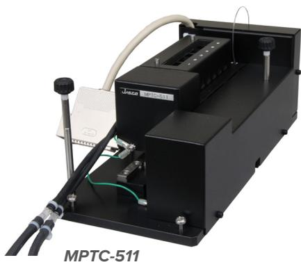
MPTC配件旨在实现高采样量和生产率。方形6连池支架允许一次最多六个样品的自动光谱扫描和平行热力学测试。适用的测量模式包括光谱扫描，单个或多个波长的热力学，以及在预设温度下进行光谱扫描的温度曲线。
