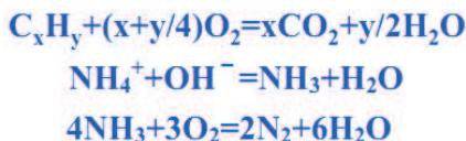
湿式催化氧化技术 (Catalytic Wet Air Oxidation,简称CWAO)是在合适的催化剂作用下，高温(150-300°C)高压(1.5Mpa-10Mpa)条件下，以氧气或空气中的氧为氧化剂，在液相中将有机污染物氧化为无机物或小分子的化学过程。利用高压反应设备实现湿式催化氧化技术是我司在环保领域的一个创新点。我司的混合器/反应器具有高速混合，高效传热，反应物停留时间的窄分布，重复性好，从而达到的高反应效率，高安全性能优势，能有效提升催化反应效率。
