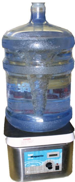
搅拌可以通过使用FAI超级磁力搅拌器进行泥浆或乳液聚合，而常规磁力搅拌器主要用于无粘性样品
