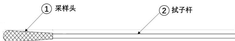
图3 无折断点通用型拭子典型结构示意图
