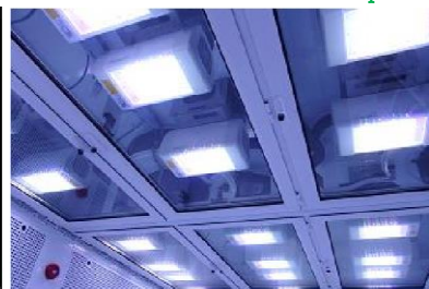
独立控制九种波长灯强度: 380nm, 400, 420, 450, 520, 630, 660, 735nm, and 5700K white
