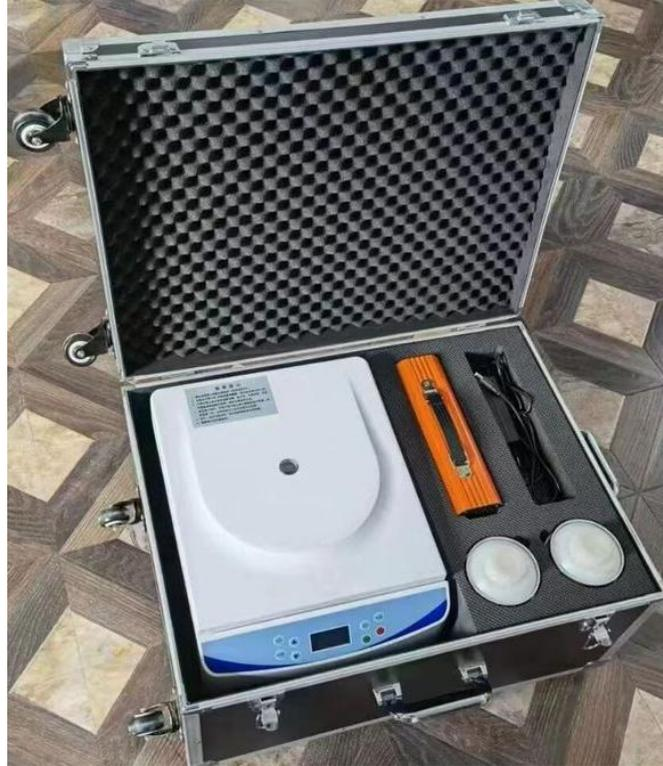
根据《中国环境监测总站文件》为了推动完善全国地表水检测技术体系建设，规范地表水总磷监测技术需要，LB-TD35 水质离心机是根据中国环境监测总站要求研发，满足《地表水总磷现场前处理技术规定(试行)》的文件，参数要求:转速 2000r/min. 最小离心设定时间 1min, 单次离心水样不小于 1L。其中水质的浊度有三个指标:<200、200-500 >500，离心机在水的浊度>500 时需要离心。
