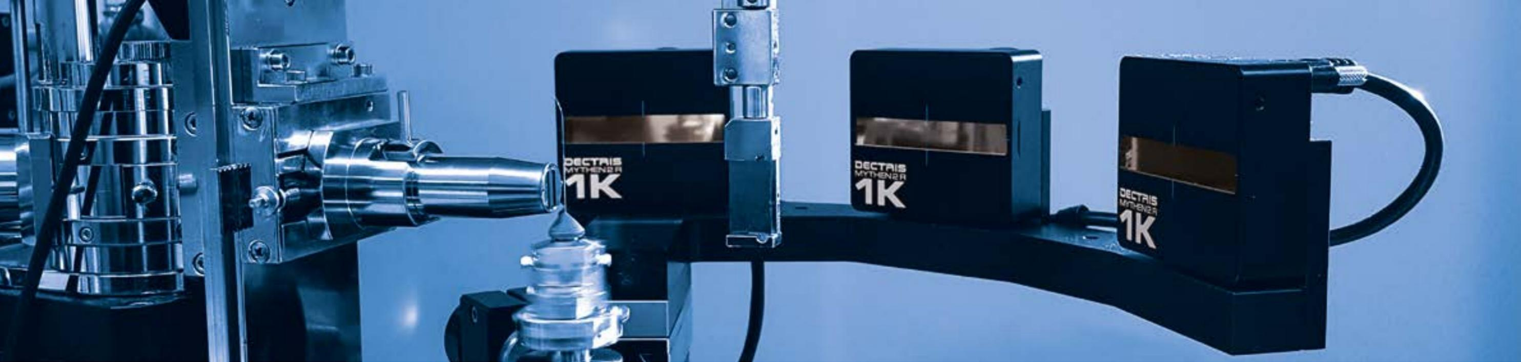
获得用于 X 射线衍射、散射或光谱实验的探测成为可能。广泛的 MYTHEN2 微带探测器产品组合可让您针对一系列 X 射线能量，进行数据覆盖范围和信噪比的优化。两种模块尺寸和四种传感器几何形状，可确保您使用非常合适的探测器收集数据。
