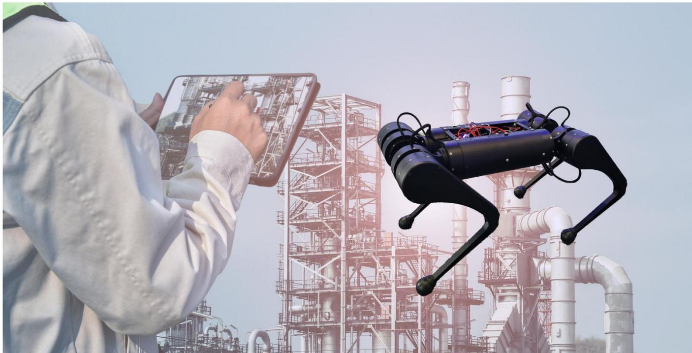
SEN AIR e-Dog 四足机器人无线监测系统是我们自主研发的一款通用型灵巧版智能四足机器人产品，产品由机器人主体、驱动系统、控制系统和视觉感知系统组成，其腿部采用仿生运动步态，具备行走、溜步、跑步等运动能力，每条腿有三个运动关节，每个关节由一个电机驱动。主要用于危险场所定位记录现场采集数据，支持远程作业指导，远程发布指令并可以将操作现场的数据回传，“机器狗”内部安装气体传感器，检测现场有害有毒气体环境，为后方处理系统提供原始数据，可实时将检测设备信息，包括数据、报警、走航图以及位置信息传至监控中心；内置模块可实时将数据上传到云端。选配搭载自组网和双光云台，侦查现场环境温度、辐射热强度、障碍物情况；兼容多种气体检测装置，获得气体变化趋势，实时描绘出污染物浓度地图，全面、快速锁定排污重点污染点位，筛查疑似污染排放源头，有需要或应急事故时实现应急车无法实现的即时快速监测。
