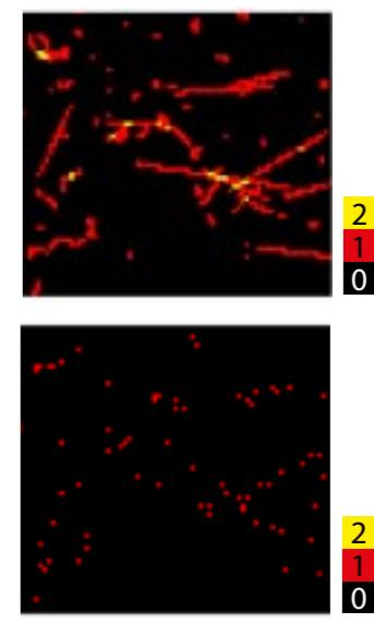
通过 EIGER2 R 探测器在 1 小时暗曝光中获得的相同区域。顶部: 用 4 keV 的低能量鉴别器获得的计数。底部: 用 10 keV 的高能量鉴别器获得的计数与用 4 keV 的低能量鉴别器获得的计数之差。
