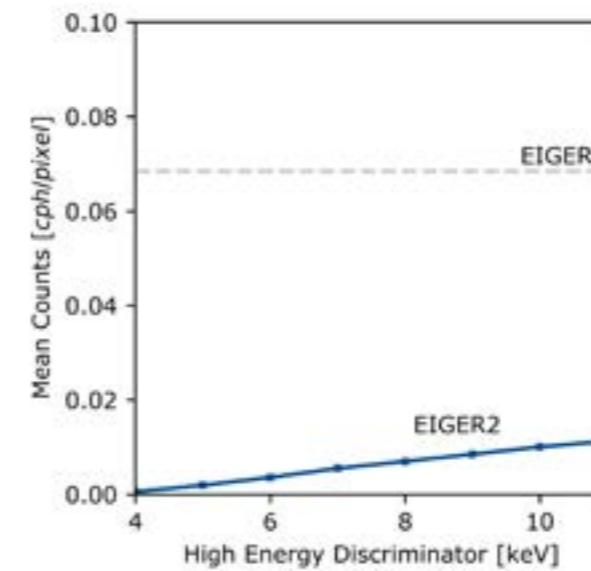
1 小时黑暗图像中每个像素的背景计数。灰色虚线: EIGER 的暗计数, 单能量鉴别器设置为4千伏。蓝色实线: EIGER2 R 的暗计数, 低能量鉴别器设置为 4 千伏, 也作为高能量鉴别器的设置函数。
