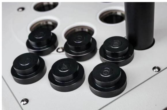
AX6 是新-代 TNM 镶埋机系列中针对大量金相镶样使用者开发而成的多模机种，可以在 15 分钟时间内产出至多 6 枚镶嵌样品，经过简化设计后的制样系统，不需繁杂设定，以量取胜。
