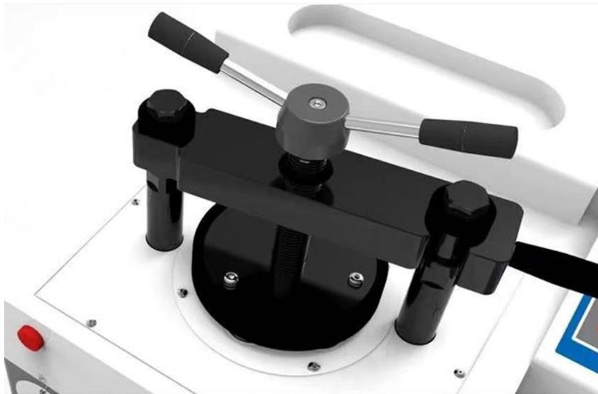
只需要将样品与树脂放入模具管当中，后将专利上模具放入并将握把靠至定位机构，回转把手锁紧装置，即可轻松完成填料作业。
