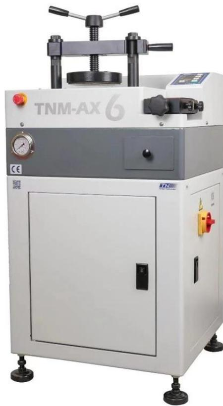
金相样品镶嵌（以下简称镶样），进行试样镶嵌的主要原因是易于处理和边缘保持，边缘保持度是指区分试样边缘和镶嵌料的能力，易于处理对手动抛光和自动抛光都有十分重要的作用，在分析试样表面的结构完整性、腐蚀影响时，边缘保持度很重要。我们所提供的镶嵌技术，能最大程度减少收缩率，在试样制备时，保护并保留试样边缘及表面缺陷。
