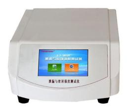
正负压密封试验仪适用于食品、制药、医疗器械、日化、电子等行业软包装件的密封试验。该设备可进行 正压测试和负压测试。通过试验可以有效地比较和评价各种试样的密封工艺及密封性能,为确定相关的技术指标提供科学依据。也可进行经跌落、耐压试验后的试件的密封性能测试。亦专业适用于各种热封、粘接工艺形成的软、硬金属、塑料包装件、无菌包装件等各封边的封口强度、蠕变、热封质量、以及整袋胀破压力、密封泄漏性能的量化测定,各种塑料防盗瓶盖密封性能、医用湿化瓶、金属桶及封盖的量化测定,各种软管整体密封性能、耐压强度、帽体连接强度、脱扣强度、热封边封口强度、扎接强度等指标的量化测定;同时也可对软包装袋所使用材料的抗压强度、耐破强度等指标,瓶盖扭力密封指标、瓶盖连接脱扣强度、材料的应力强度、以及整个瓶体密封性、抗压性、耐破性等指标进行评估分析。相比传统设计真正实现了智能化测试:多组试验参数预置可大幅提高检测效率。
