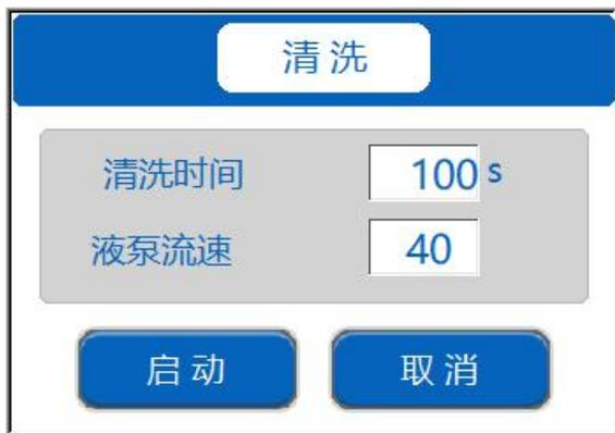
清洗操作将按默认的液泵流速和运行时间进行泵路循环，清洗参数可进行更改设置，按“停止”键随时结束清洗过程。
