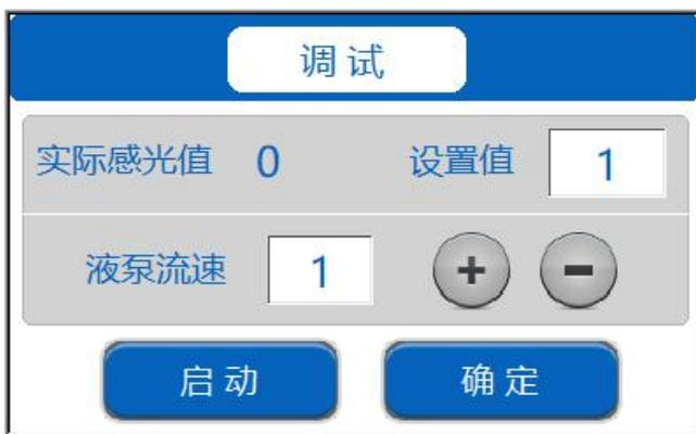
此弹出窗口可以启动/停止液泵和感光装置的运行，可根据实际感光值来确定停止值，并可以通过调大或调小按钮进行流速的调节，以此来选择最佳流速。
