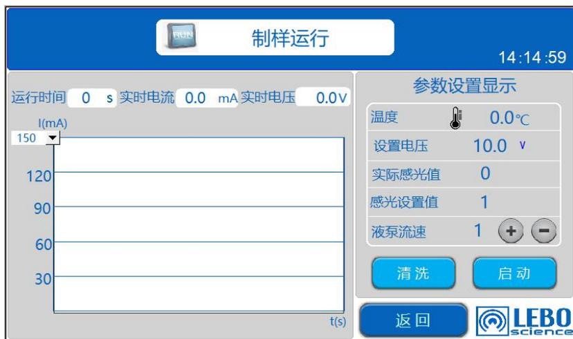
按“启动”按钮将按照选择的感光值、抛光电压和液泵流速进行抛光制样运行。
