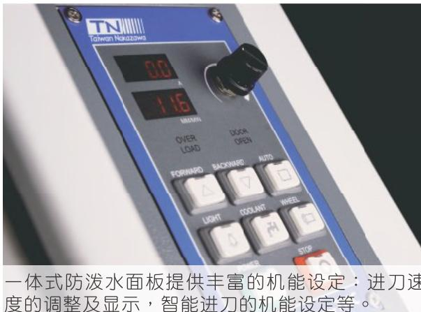
一体式防泼水面板提供丰富的机能设定：进刀速度的调整及显示，智能进刀的机能设定等。
