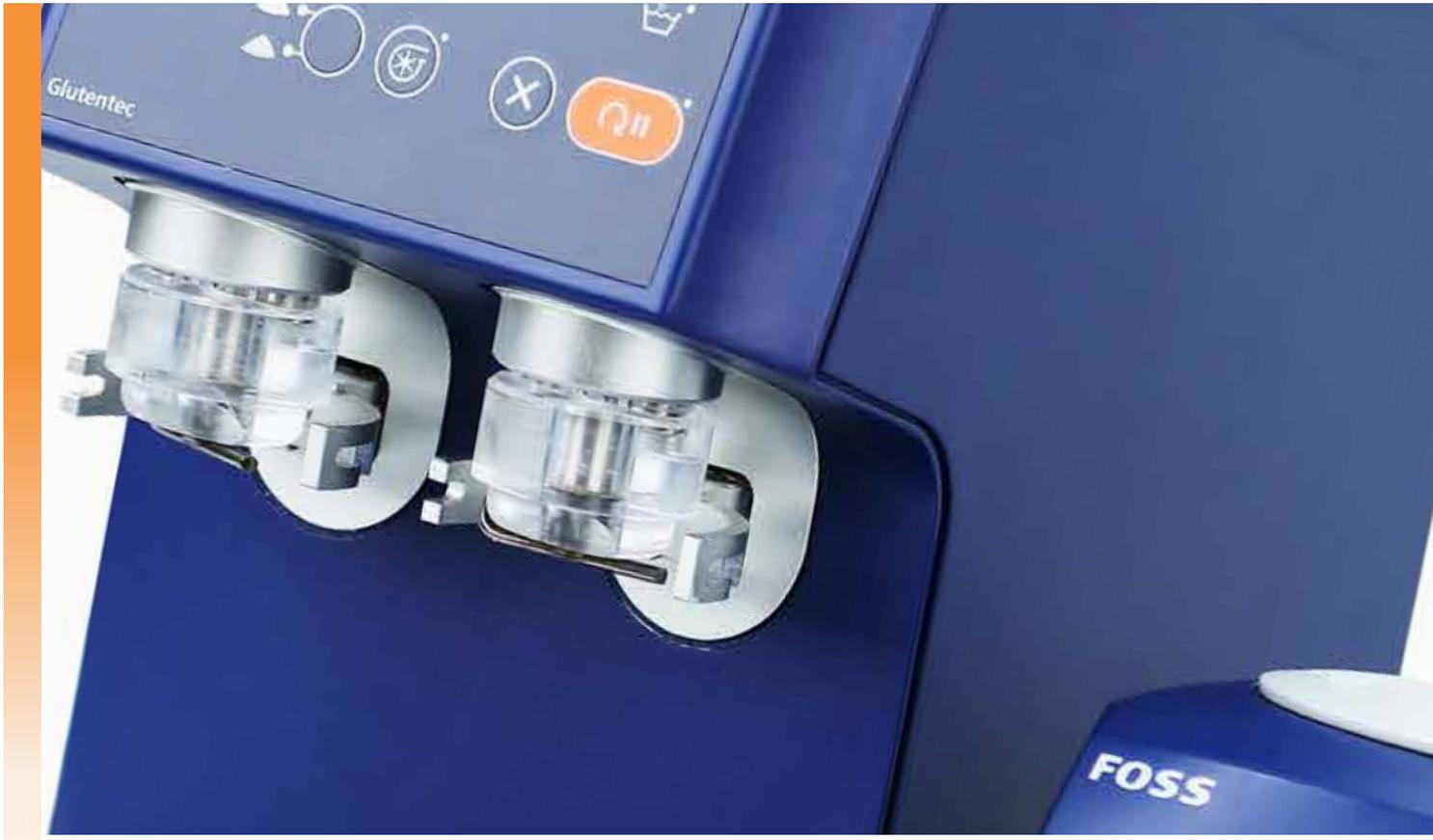
Glutentec™ 是一套全新的用于检测面粉质量的分析解决方案。该解决方案结构坚固耐用，过程快速可靠，不到 10 分钟就能得出检测结果。
