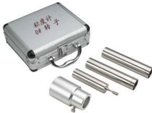
0号转子 适合测量低粘度样品
