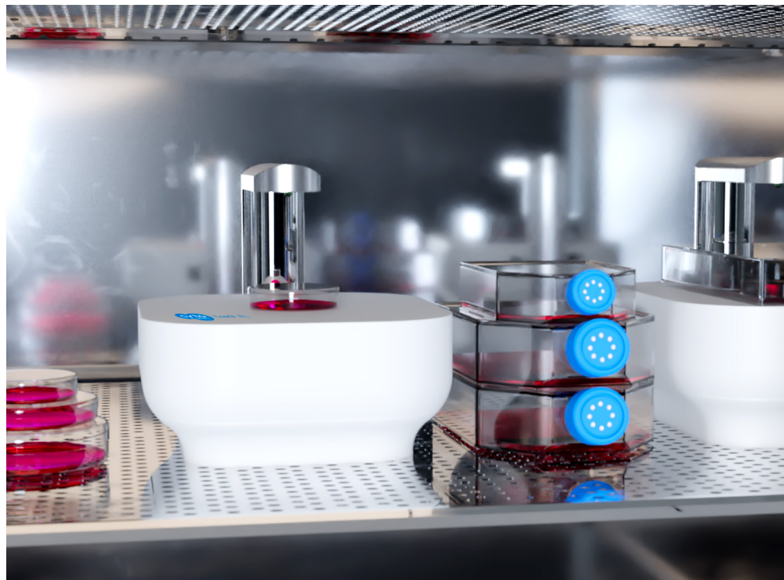
图 7. CytoSMART™Lux3 FL的开放式设计可轻松监控培养箱内培养的细胞。
