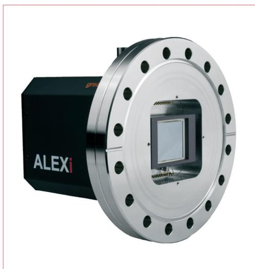
出身于柏林的ALEX是德国greateyes公司最新研发，应用于极紫外，真空紫外和X射线能段的光谱及影像相机。ALEX集成了目前最前沿的低噪声电子系统和超低温制冷技术，同时保持了紧凑小巧的设计。全新的设计允许从50 kHz至5 MHz灵活地选择所需读出速度。18-bit 的模数转换能够利用CCD传感器的全动态范围，以达到更好表现和更高的信噪比。为匹配不同应用的需求，该相机包括多种类型的传感器可供用户选择。同时ALEX的低噪声使之成为极弱信号条件下所需的理想相机，它将给您的光谱学和影像研究带来前所未有的可能性。封面所示纳米尺度的软X射线影像为德国Max Born研究所和Helmholtz柏林研究所的共同合作成果。
