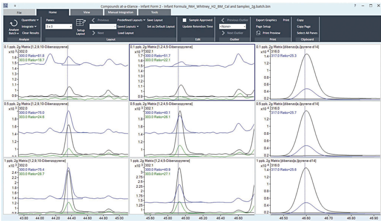
高度可定制的“化合物概览”视图，显示了校准浓度为 0.1、0.5、1 ppb 的 1,2,9,10-二苯并芘、1,2,4,5-二苯并芘和二苯并[a,h]芘-d14。
