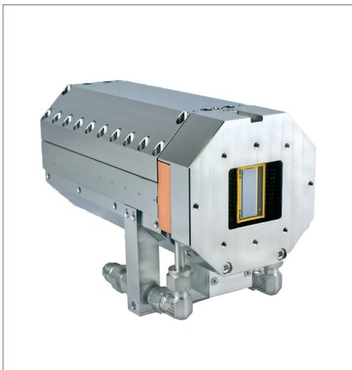
出身于柏林的LOTTE是德国greateyes公司最新研发, 应用于极紫外, 真空紫外和X射线能段的光谱及影像内真空相机。LOTTE集成了目前最前沿的低噪声电子系统和超低温制冷技术, 同时保持了紧凑小巧的设计。全新的设计允许从50 kHz至5 MHz灵活地选择所需读出速度。18-bit 的模数转换能够利用CCD传感器的全动态范围, 以达到更好表现和更高的信噪比。为匹配不同应用的需求, 该相机包括多种类型的传感器可供用户选择。同时LOTTE的低噪声使之成为极弱信号条件下所需的理想相机, 它将给您的光谱学和影像研究带来前所未有的可能性。封面所示纳米尺度的软X射线影像为德国Max Born研究所和Helmholtz柏林研究所的共同合作成果。
