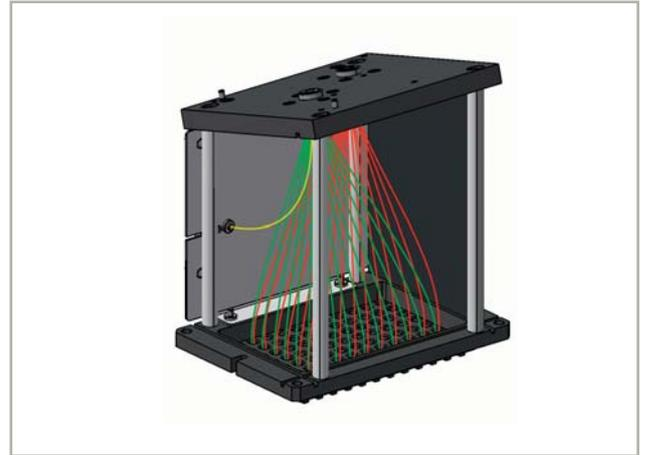
图1：新的光路系统由2×96根等距玻璃光纤组成。每个孔对应2根光纤，一根用来传导激发光（绿色），另一根用来收集荧光信号（红色）
