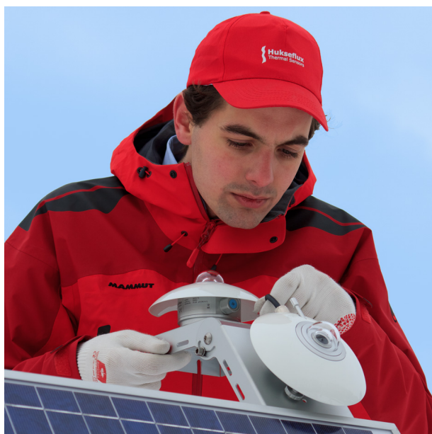
图2 光伏系统性能监测中的双辐射表应用
