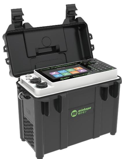
MH3300型烟气烟尘颗粒物浓度测试仪 (22代) 是集烟尘颗粒物采样、颗粒物浓度检测、烟气污染物采样检测于一体的便携式污染源检测设备。新升级控制系统，系统更稳定，控制更精准。针对污染源烟尘颗粒物，本设备可实现重量法采样及 $\beta$ 射线吸收法颗粒物浓度直读两种功能。针对污染源烟气污染物，本设备可完成基于电化学测量法、溶液吸收法的多种污染物的浓度测量。内置大容量电池，交流、直流随意切换，确保仪器稳定可靠。新升级烟气测量系统，确保低温环境下超低误差、快速响应。本设备采用高度集成化设计思想，烟尘烟气可同步采样或测量，可选配多种采样管，实现一机多用的目的。
