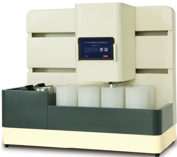
北京同泰联科技发展有限公司新研制的TTL-580型全自动刀式研磨仪，基于平板电脑无线控制的全自动研磨样品和转刀清洗过程。配置独立的清洗池，可以有效地避免处理过程中样品间的交叉污染；从研磨（均质化）样品、三级清洗转刀程序，全部由仪器自动完成。极大地提高了样品前处理效率，有效消除了研磨样品时人为操作的差异。提高了研磨（均质化）样品的效率。
