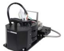
MPTC-513 珀尔帖效应恒温槽 6 转台矩形样品池
