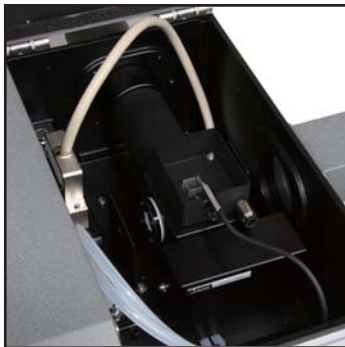
PTC-517 珀尔帖发射光组样品池支架和 PML-534 高灵敏度 FD CD 检测器
