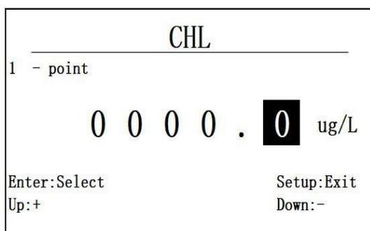
图 6.7.3.1 两点校准第一点校准值“0”
