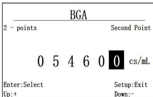
图 6.10.3 两点校准第二个校准点输入
