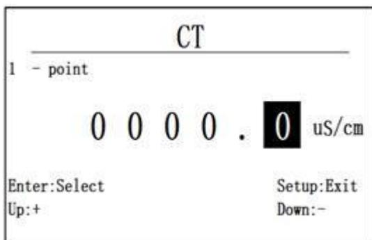
图 6.5.2.1 一点校准输入界面
