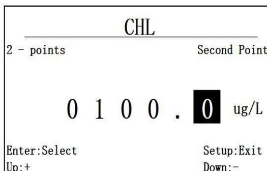
图 6.7.3.2 两点校准第二个校准点“100”
