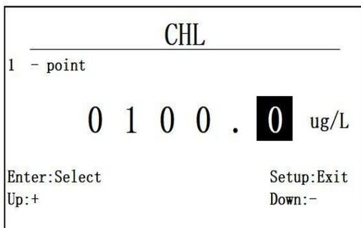
图 6.7.2.1 探头一点校准校准值输入
