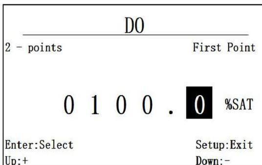
图 6.3.3.1 第一个校准点输入
