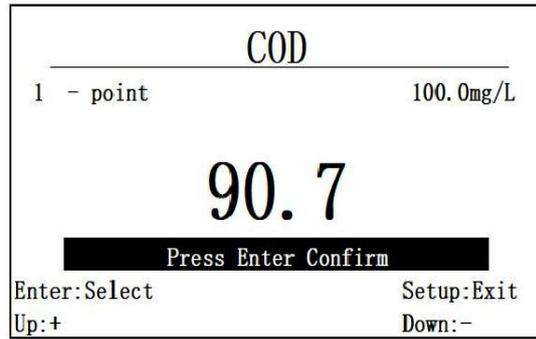
图 6.12.2.2 一点校准校准数据显示
