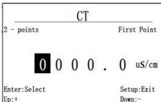
图 6.5.3.1 两点校准第一点标准值“0”
