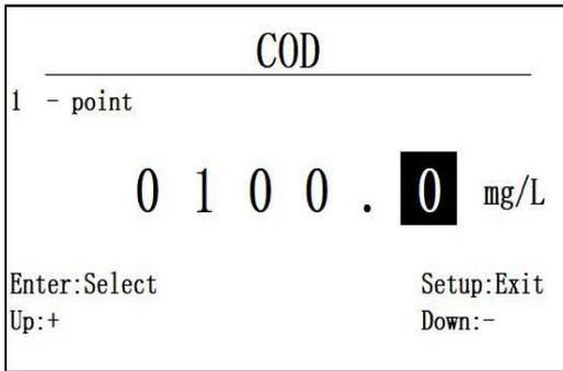
图 6.12.2.1 一点校准时校准值输入
