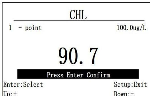
图 6.7.2.2 叶绿素一点校准数据显示
