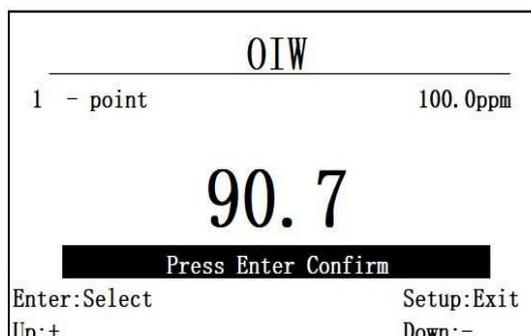
图 6.11.2.1 一点校准校准值输入
