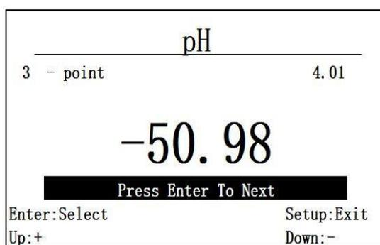
图 6.13.1 pH 的第一个校准点
