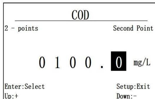
图 6.12.3.2 第二个校准点校准值“100”
