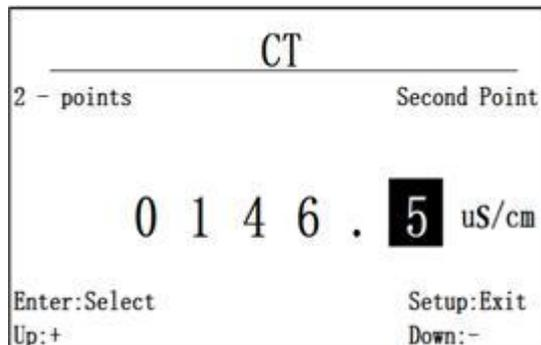
图 6.5.3.2 两点校准第二点标准值“146.5”
