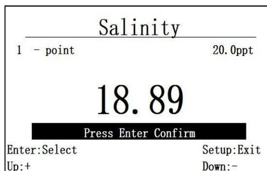
图 6.4.2.2 盐度探头校准进行界面
