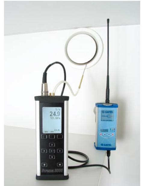
使用无线调制解调器进行远距离风平衡
