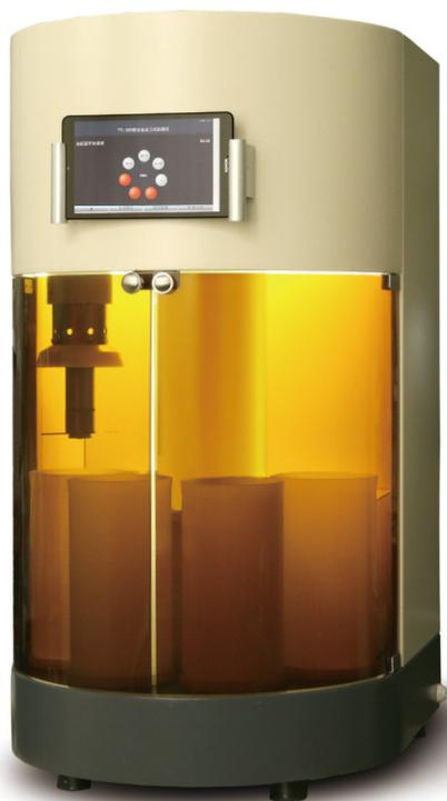
北京同泰联科技发展有限公司新研制的TTL-500型全自动刀式研磨仪，基于平板电脑无线控制的全自动研磨样品和转刀清洗过程。配置独立的清洗池，可以有效地避免处理过程中样品间的交叉污染；从研磨（均质化）样品、三级清洗转刀程序，全部由仪器自动完成。极大地提高了样品前处理效率，有效消除了研磨样品时人为操作的差异。提高了研磨（均质化）样品的效率。
