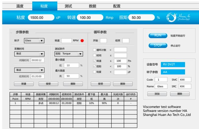
分析图可选择坐标与单位，同时显示运行曲线进度条与到达温度点时间，记录数据：步骤、炉温、样温、粘度、转速、扭矩、剪切力、剪切率、时间等，导出数据为 Excel 格式，简捷方便，界面友好。
