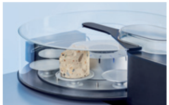
最多支持 8 个大型样品 (96 mm) 或者大小样品的随机组合
