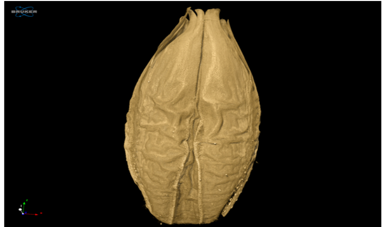
三维渲染 8 \mu\text{m} 体素、70 kV、1 mm 铝滤光片、1944 x 1944 x 3980 像素 — 6 mm 样本大小
