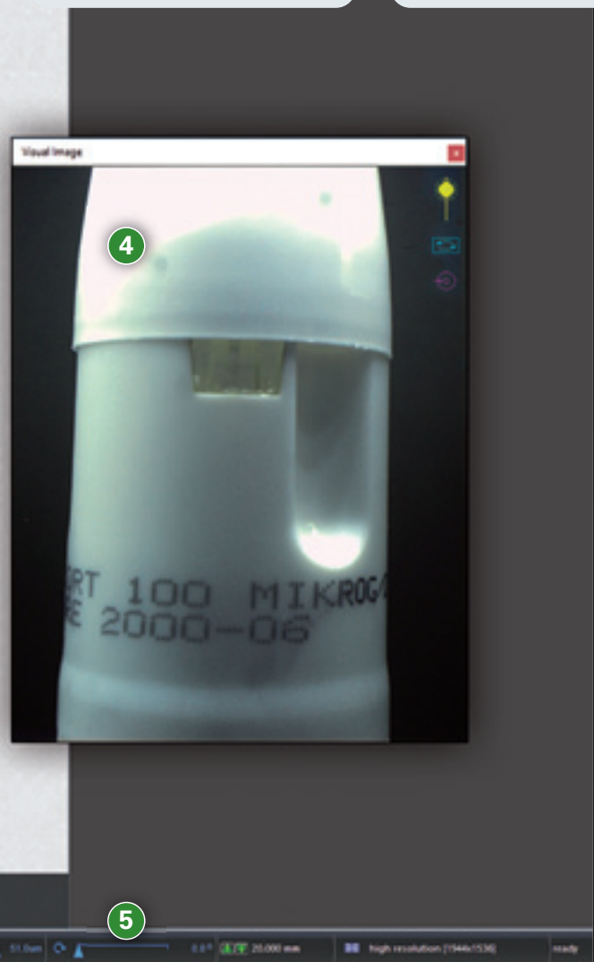
SKYSCAN 1275 控制软件窗口一览 吸入器，40 \mu\text{m} 体素，100 kV，1 mm 铜滤光片，972 x 768 像素
