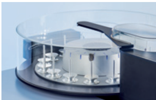
最多支持 16 个样品，最大直径为 45 mm
